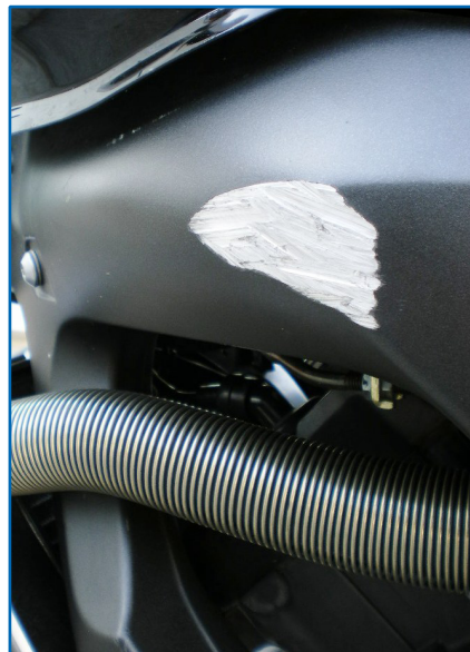
Un simple dommage esthétique et le cadre est à remplacer selon certains constructeurs...
