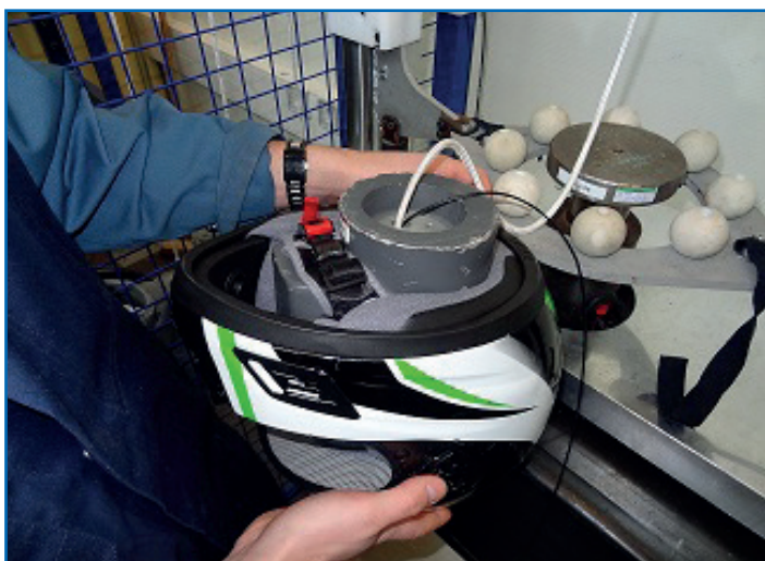
Fausse tête équipée de l'accéléromètre placée dans le casque
