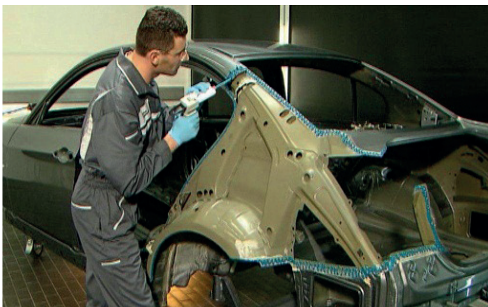
Rivetage-collage : pose d'un cordon de colle
