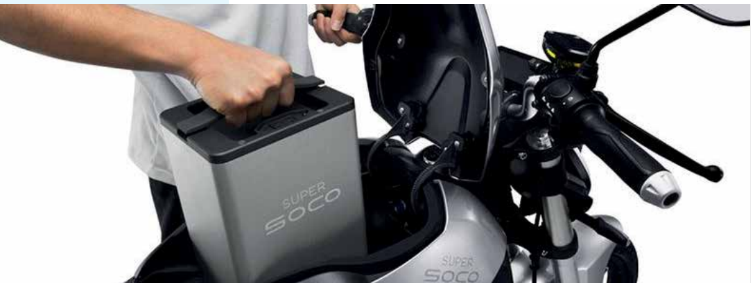
Pack composé de modules + BMS
